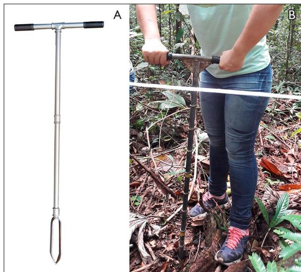
Figura 5. Coleta de solo: A) ilustração do trado holandês; B) extração do solo com auxílio do trado holandês em campo, na fitofisionomia de mata primária, na DENPASA S/A. Foto: Martins, A. M. (2018).
